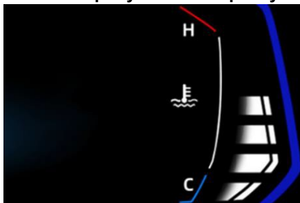
Ukazatel teploty chladicí kapaliny 2
