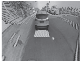
Obrázek 8 Zadní pohled ve 3D a odbočení bez zařazení zpátečky
