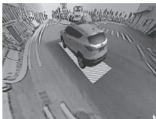
Obrázek 9 Levý zadní pohled ve 3D při odbočení vlevo bez zařazení zpátečky
