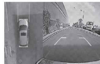
Obrázek 10 Funkce přední pomocné čáry přední části vozidla
