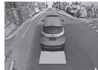
Obrázek 9 Pravý přední pohled ve 3D při odbočení vlevo bez zařazení zpátečky
