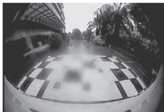
Přední kamera ovlivněná vodou
