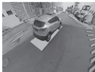
Obrázek 9 Pravý zadní pohled ve 3D a odbočení vlevo bez zařazení zpátečky
